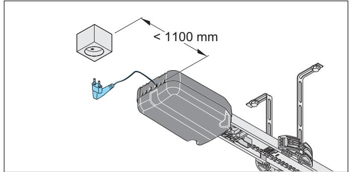
Abb. Abstand der Deckensteuerung zur Steckdose
