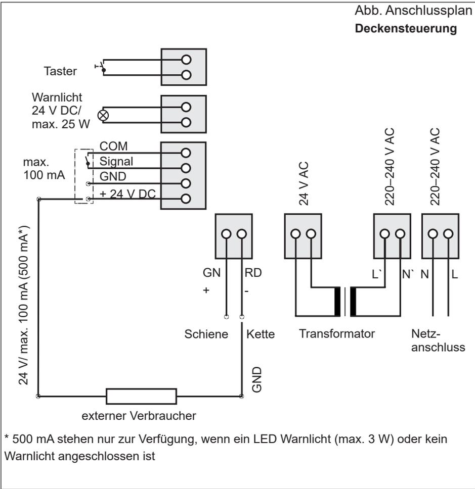
Beim Anschluss externer Verbraucher muss der Energiesparmodus deaktiviert werden, damit die Spannungsversorgung sichergestellt ist.
