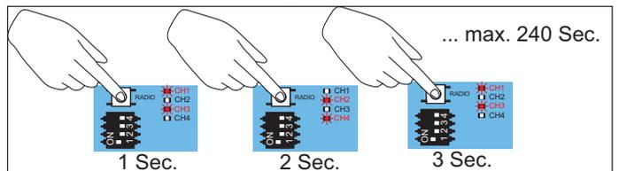
4. Die Offenhaltezeit an den Leuchtwechseln der LEDs abzählen. Wenn die gewünschte Dauer erreicht ist, die RADIO-Taste loslassen.
